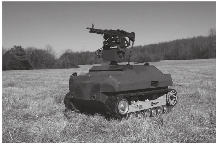
Figura 7: Un tanque robótico
